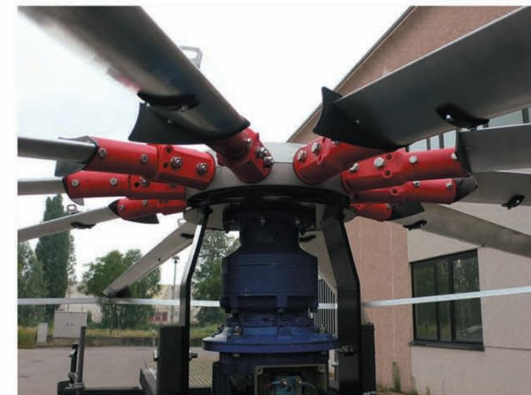
Particolare attacco pala per diametri 5-6-7-8 metri
